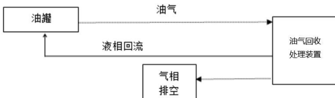
图 2.6-5 油气回收处理装置工艺流程图
