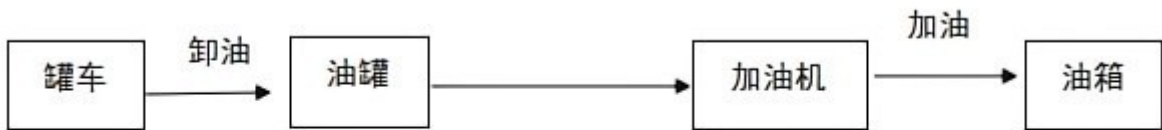
图 2.6-2 柴油卸油、加油工艺流程图
