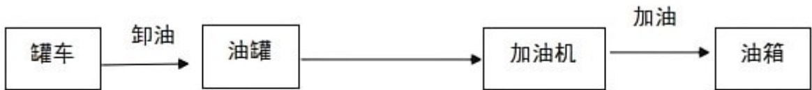
图 2.6-2 柴油卸油、加油工艺流程图
