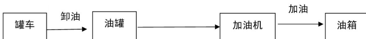
图 2.6-1 汽油卸油、加油、油气回收工艺流程图
