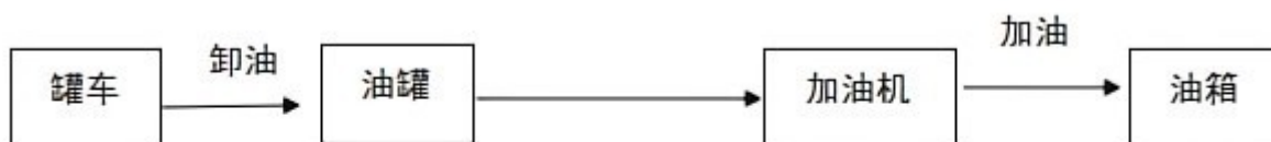
图 2.6-2 柴油卸油、加油工艺流程图
