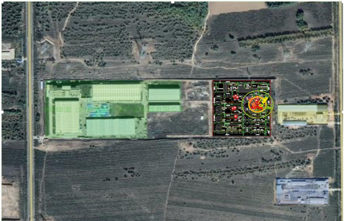
图 D.2.4-5 DMF 储罐中孔泄漏后发生蒸汽云爆炸事故后果预测图
